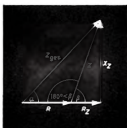
Bild 6. Vektordiagramm nach Bild 3 mit Widerstandsvektoren
